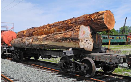
Skeleton log car mit Hauptholm in Holz (Bild: Bernd Seiler, Port Alberni)
