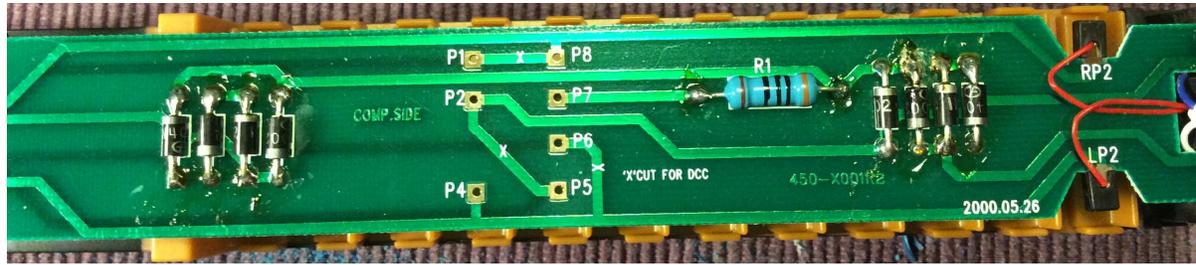
Vorsichtig an drei Stellen, markiert mit X, die Leiterbahn durchtrennen. Alle 8 Dioden sowie den Widerstand R1 auslöten und entfernen. Anstelle von D4 eine Drahtbrücke einlöten.
